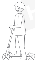
3. על מנת להתחיל לנוע, הדוף את עצמך על ידי הרגל שעל הקרקע. יש להגיע למהירות מינימלית של 5-5 קמ"ש, הרם את הרגל מהקרקע לקורקינט, מעט מאחורי הרגל המובילה.
